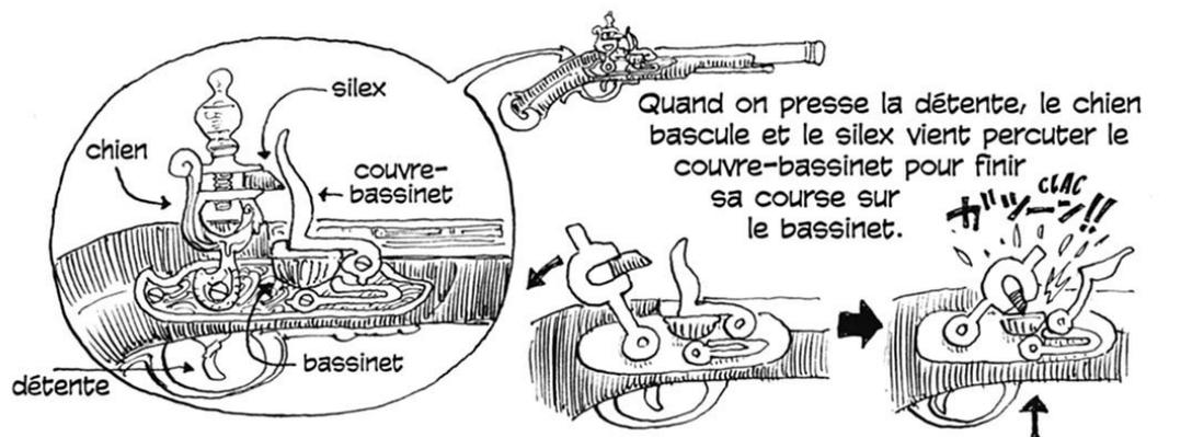
Quand on presse la détente, le chien bascule et le silex vient percuter le couvre-bassin pour finir sa course sur le bassin.
